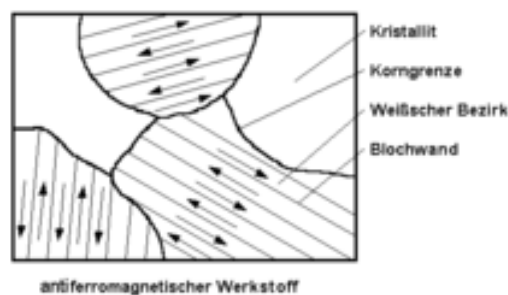
Abbildung 6.5.: Antiparallele Ausrichtung gleichgroßer Domänen bei Antiferromagnetika (Quelle:[])
