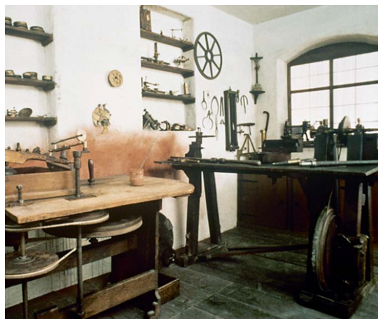
Abbildung 3.1.: Linsenschleif- und Polierbänke aus Fraunhofers Werkstatt (Quelle:[13])
