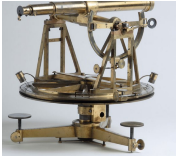
Abbildung 4.3.: Heliometer für die Sternwarte Königsberg (Präzisionsinstrument zur Messung des Winkelabstands) (Quelle:[36])
